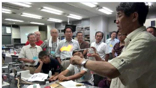
上の写真は、白金箔のプラスチックをバーナーで燃やして、完全にプラスチックが燃えたところで、水素を吹きかけて水素の燃焼(白金の触媒作用)を確認しているところ。
