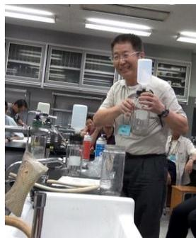
もし良かったら、2000 円で購入して下さい。水素の出口のピンチコックを開くと水素が出て行きます。硫酸が落ちてきて、水素を追い出していく感じですよ。一番最初は、空気と水素が混じっていますから、少し多めに水素を発生させて、逃がしてやります。そしたら、水素のシャボン玉を作って、水素は軽いということを見せます。運動神経の良さそうな生徒を指名して、水素シャボン玉に火をつけさせるんです。水素のシャボン玉は、フワフワと勢いよく上昇していくものだから、なかなか火がつかないんです。それで、結構生徒たちは、「ワーッ!!」と盛り上がる実験です。では、火をつけてみてください。火がつくと、「ポーッ」と静かに燃えます。生徒は、試験管にためた水素がピョンと音をさせて燃えることが、印象深く残っていますから、静かに「ポーッ」というのは、とても意外な燃え方です。
